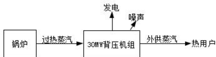
图 2-1 1×B30MW 背压机组项目工艺流程图
